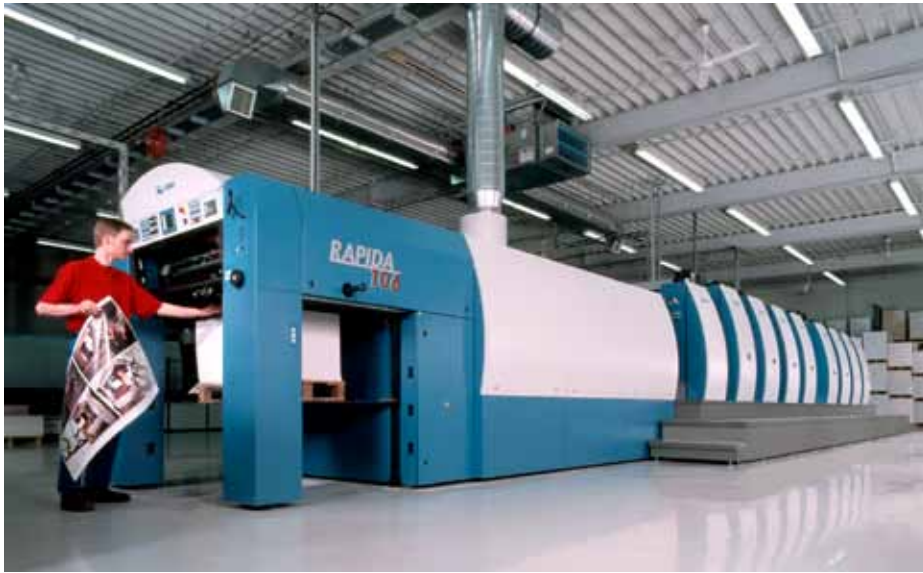
Ein ganz entscheidender Aspekt beim Entscheid zugunsten der Rapida 106 waren die Qualitätskontrolle, die Mess- und Regeltechnik und der Direktantrieb mit dem Flying JobChange.
